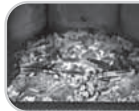
Afslutningen af afbrændingsprocessen opnås, når træet er brændt fuldstændigt, og der ikke kan opstå ulmning eller ufuldstændig forbrænding. Nu kan betjeningsgrebet lukkes (venstre position).
